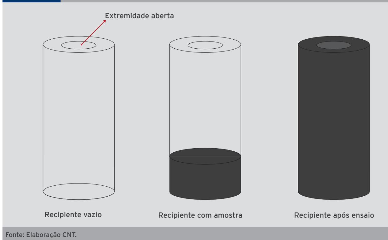
Para avaliar o efeito do calor e do ar, são comparadas as propriedades da amostra antes e depois do ensaio RTFOT. Comparam-se a variação da massa, a ductilidade a 25 °C, o aumento do ponto de amolecimento e a penetração do material, todas expressas em termos da variação verificada.
